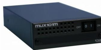
本装置は、1系統のHD-SDI入力信号にAES3idフォーマットのデジタル音声信号を4系統(8ch)までHD-SDI信号に多重して出力する、HD A/V マルチプレクサです。
