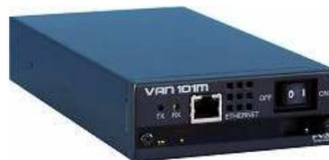
本装置は、外部機器のCOMポートより送出されるデータを受信しHD-SDI信号に重畳させる送信機能と、HD-SDI信号に重畳されたデータをCOMポートに送出する受信機能を有した装置です。
