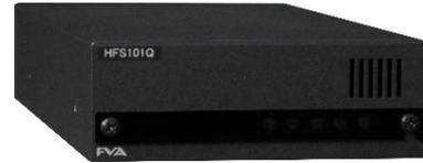
マルチフォーマットSDI信号に対応したエンベデッドオーディオタイプのフレームシンクロナイザーです。対応する映像フォーマットは、1080i/59.94, 720p/59.94, 1080i/50, 720p/50の4種類です。SDI入力信号から分離された音声信号は、レートコンバータで出力側映像フレームに同期した音声サンプリング周波数に変換され、再び出力SDI信号に多重されます。8chまでの音声信号に対応できます。
